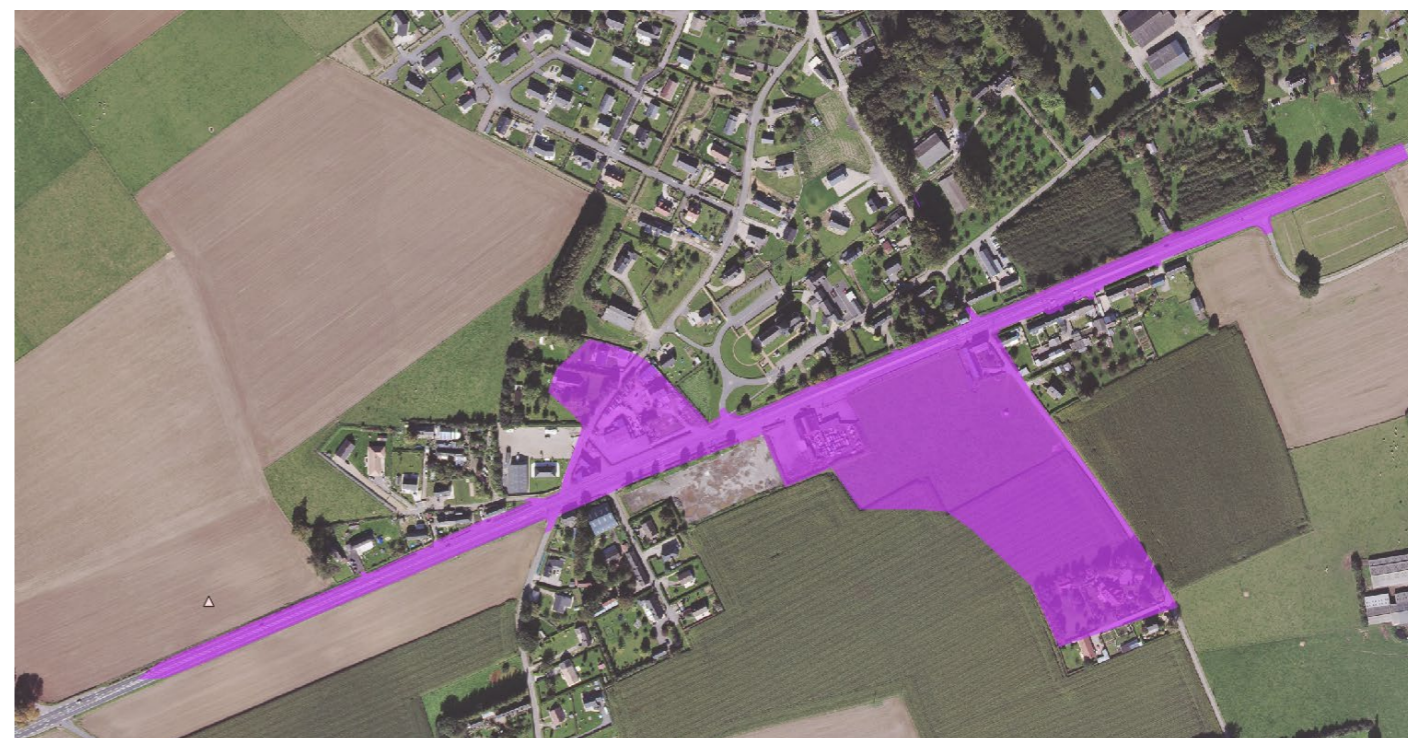
Schéma 15 : Superficie totale du bassin versant intercepté par le projet
